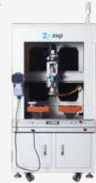
双工位锁螺丝机+支持三种螺丝
