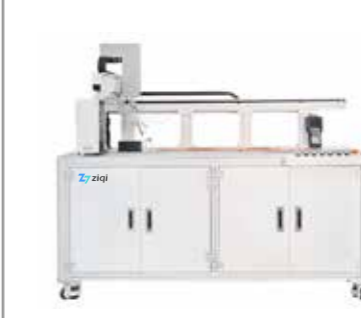
落地式三轴自动焊锡机 (超长行程)
