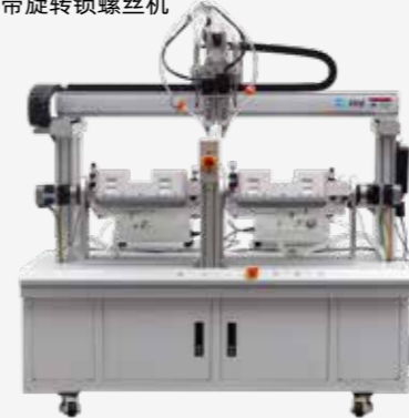
双工位Y轴带旋转锁螺丝机
