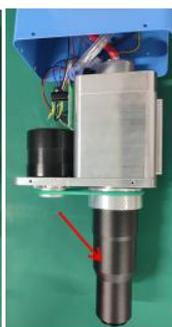
2. 拆下喷嘴连接杆
