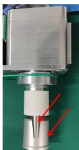
4. 拆下电极套、电极、
